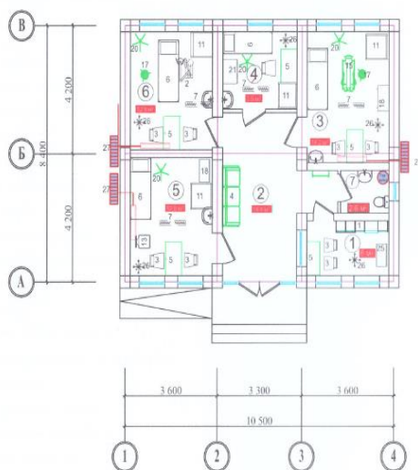
План расстановки технологического оборудования первого этажа
